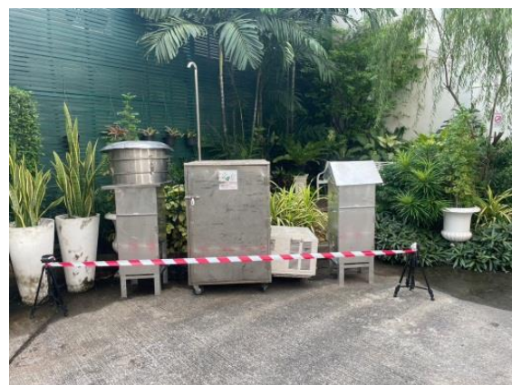
รูปที่ 3.3 การเก็บตัวอย่างคุณภาพอากาศในบรรยากาศ บริเวณภายในโรงพยาบาลพญาไท 2
